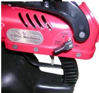
Per diminuire la pressione ruotare in **senso antiorario**
