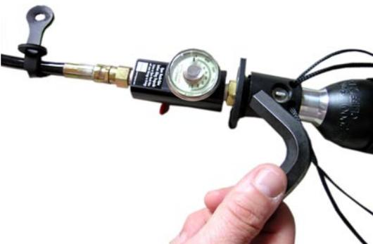
Prendere la chiave a L e ruotare in senso antiorario 90° la valvola di chiusura. La valvola dovrà essere perpendicolare rispetto al flusso dell'aria.
