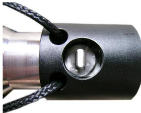
Se la valvola è chiusa non procedere con il caricamento di aria compressa. Si possono danneggiare gli O ring interni dell'ugello **NON CARICARE**
