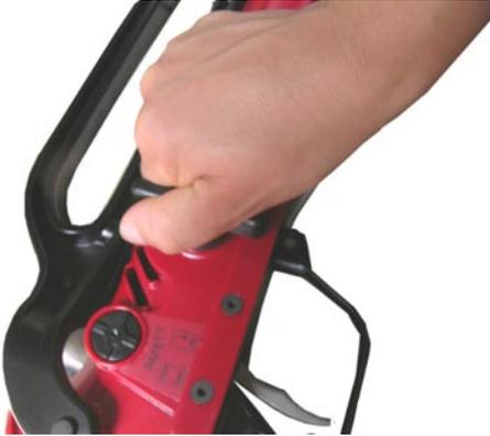
Tenendo premuto ruotare in senso orario a 90° a fine corsa.
