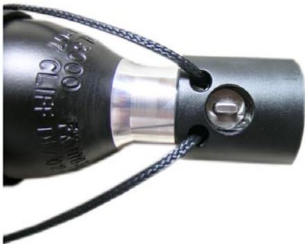
Controllare che la valvola dell'ugello sia aperta nel senso del flusso dell'aria
