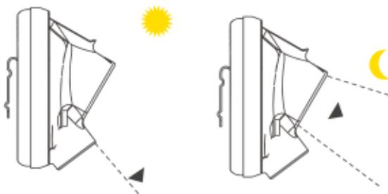
L'intensità e la durata del fascio di luce sono gestiti automaticamente per mezzo di un sensore di luce ambientale: evita danni visivi tra gli utilizzatori e risparmia la durata della batteria
