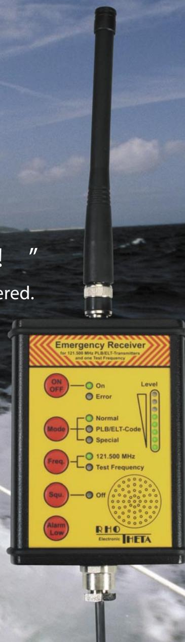
L'RT-100 Ricevitore di Emergenza monitorizza la 121.5 MHz ,frequenza internazionale di emergenza ed emette un segnale acustico di allarme se un segnale è ricevuto. Allo stesso tempo un relè è attivato e può essere usato per accendere dispositivi esterni di allarme. Quando la funzione squelch è attivata viene rilevato solo un allarme reale ricevuto da un trasmettitore di emergenza tipo
